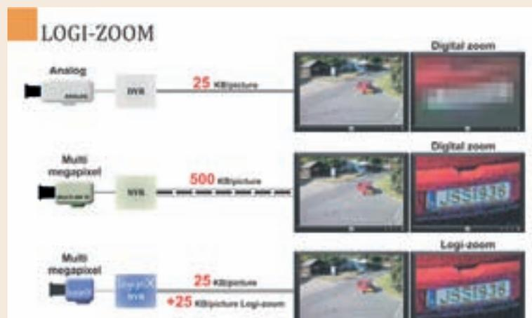
consente all'utente di visualizzare i dettagli di interesse contenuti nelle immagini multi-megapixel in alta risoluzione, mentre il resto dell'immagine viene trasmesso a risoluzione più bassa in modo da ottimizzare l'occupazione di banda. Logipix utilizza lo standard di compressione JPEG2000, che è stato sviluppato appositamente per la gestione di immagini ad alta risoluzione, dove la scalabilità è una delle caratteristiche
