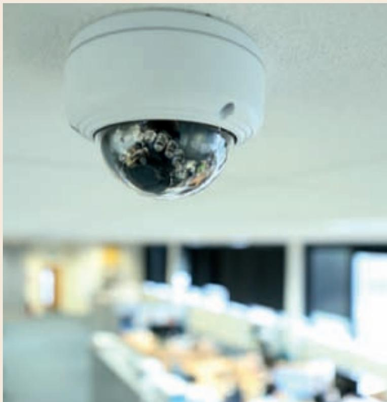
fattori differenzianti. La videocamera è dotata di un angolo di visuale ampio che permette una migliore sorveglianza dell'area inquadrata. Il modulo ICR integrato e i led a infrarossi – in grado di illuminare fino a 20 metri di distanza – consentono una videosorveglianza perfetta anche durante le ore notturne e in assenza totale di luce. La qualità dell'im-
