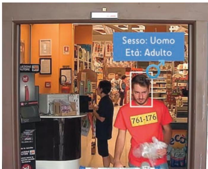
**Figura 1** - Esempio di riconoscimento del sesso e dell'età di una persona all'ingresso di un supermercato effettuato da AI-BIO, il plugin di video analisi di A.I. Tech per il riconoscimento del sesso e la stima dell'età.
